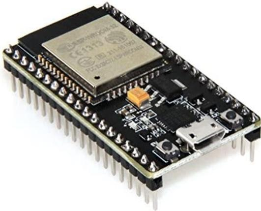
El sistema embebido Iot que se utiliza para la prueba es desarrollado gracias al microcontrolador Esp32 de la compañía de Espressif Systems, que goza de un microprocesador Tensilica Xtensa LX6 con frecuencia de procesamiento de 240 MHZ lo que quiere decir que cada segundo es capaz de realizar 240 millones de instrucciones que se le sean programadas, esto es solo en un nucleo
