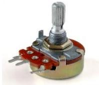
Para la prueba física del diagrama general se empleó como sensor un potenciómetro de 10 kilo ohms de impedancia que se conectó de manera adaptativa al sistema embebido IOT con fines de mostrar una señal que manda dicho potenciómetro atravesando todo el concepto del diagrama y con ello mostrarlo en una gráfica en la interfaz de usuario.
