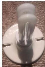
Para la prueba física del diagrama general se empleó como actuador un bombillo conectado a la red eléctrica en conjunto con un relevador electromecánico, el sistema embebido IOT controla el relevador electromecánico y con ello prende y apaga el bombillo de forma indirecta.
