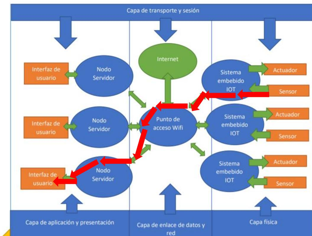
**Paso 1.** El sensor obtiene lecturas de la variable física a la que se la haya asignado respectivamente y posteriormente es transmitida hacia el sistema embebido IOT a través de un medio alámbrico.
