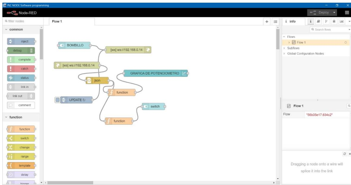
El software Node-Red te brinda herramientas en formas de bloques de programación para utilizar diversidad de funcionalidades, para implementar por parte de la investigación que se llevo a cabo del mejor protocolo de comunicación se recurrió al bloque de programación llamado Websockets.
